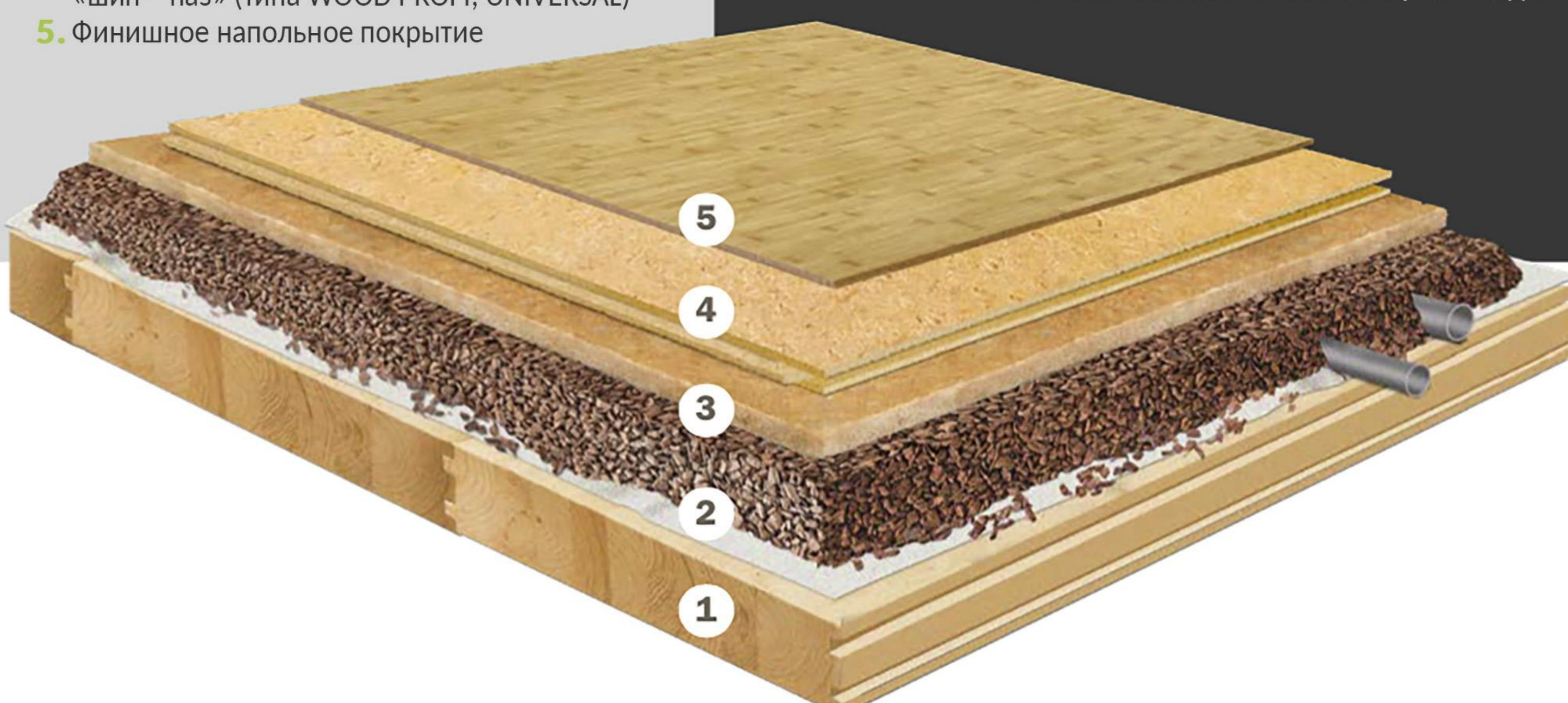
**10 | CW 2000:** Пример заполнения пустот между деревянными балками
