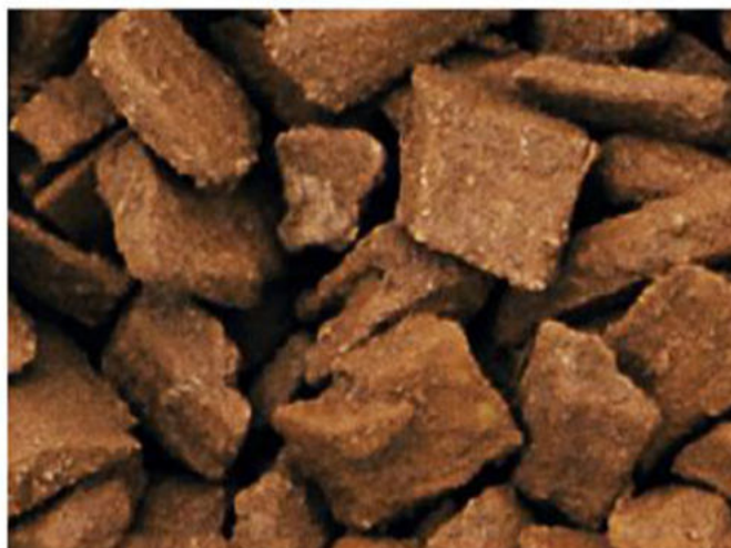
Деревянные гранулы с минеральным покрытием без видимых следов роста плесени к моменту окончания эксперимента
