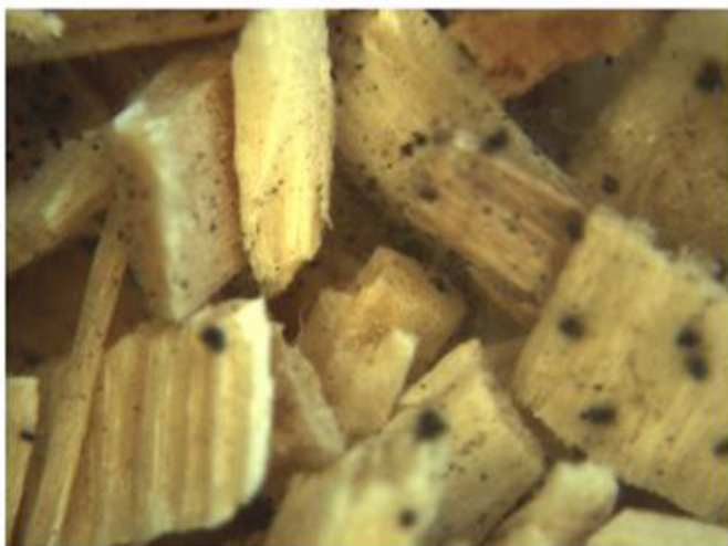
Рост плесени на необработанной древесной щепе к моменту окончания эксперимента
