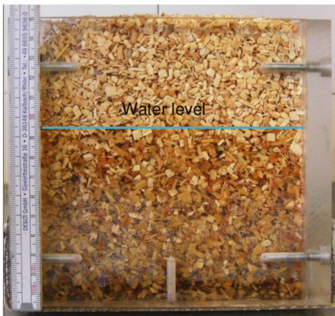
Уровень воды в 95 мм в контейнере с необработанной древесной щепой через 7 дней
