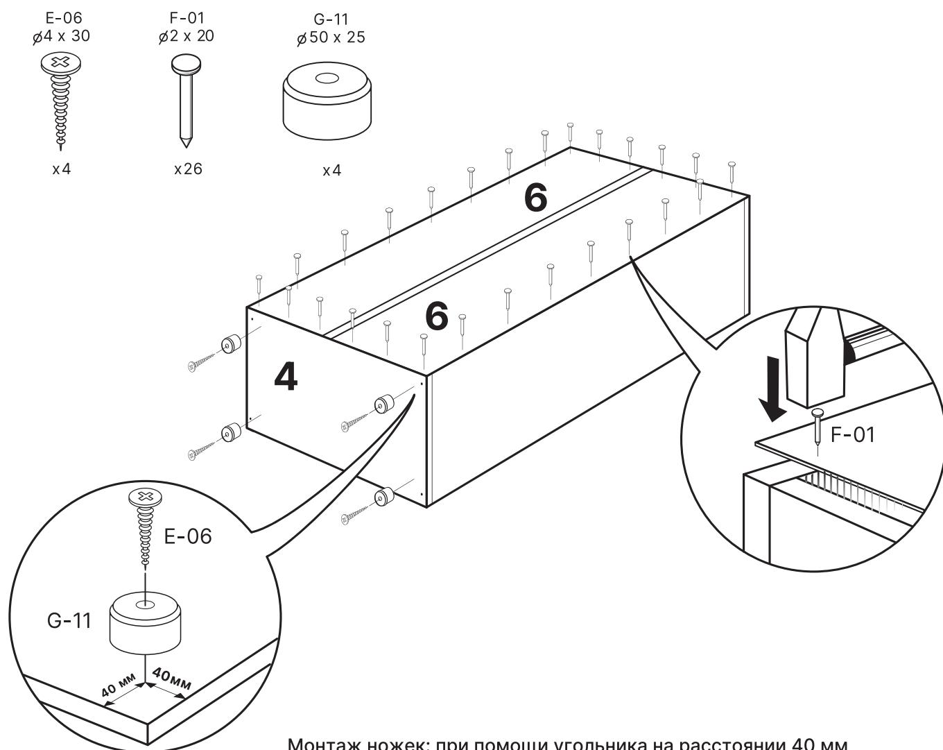
Монтаж ножек: при помощи угольника на расстоянии 40 мм от каждой стороны, примыкающей к углу, делаются заметки на нижней детали №4.
