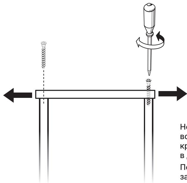
Не полностью закрученные конфирматы дают возможность вручную центрировать верхнюю крышку шкафа в необходимое положение в диапазоне 1-2 мм.
