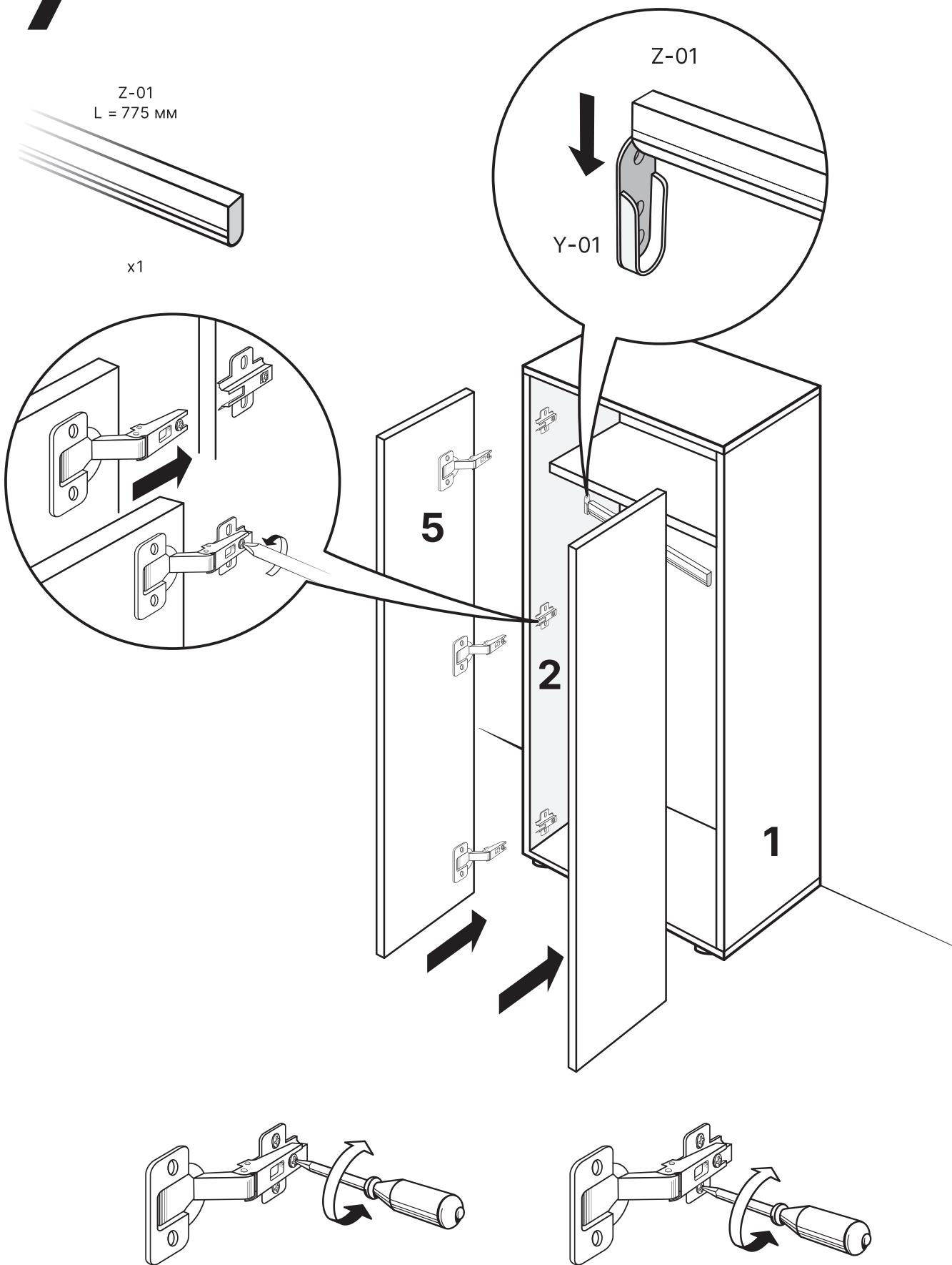
Отрегулируйте вертикальное и горизонтальное положение дверной створки при помощи петель.
